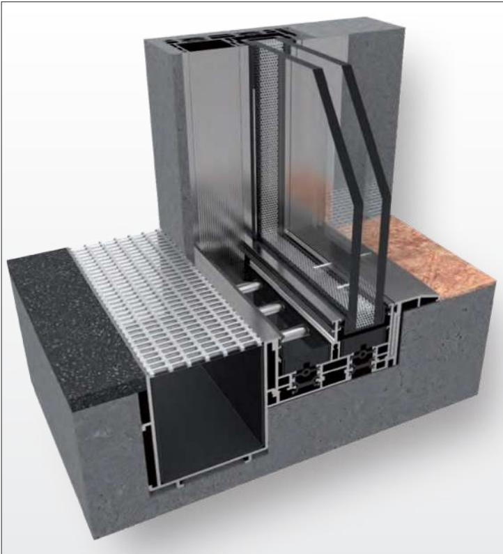
Tamamı duvara gömülebilen, yağmur suyu tahliye ızgarası da içeren pencere sisteminden **yan kesit** (iç ve dış görünüm).
