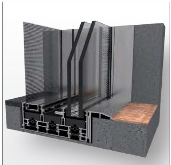
Tamamı duvara gömülebilin, sineklik de eklenebilen 3 ray çerçeveli pencere sisteminden **yan kesit** (iç ve dış görünüm).
