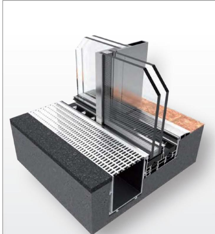
Tamamı duvara gömülebilen, yağmur suyu tahliye ızgarası da içeren pencere sisteminden **orta kesit** (iç ve dış görünüm).
